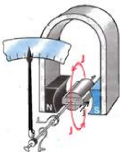
Это и амперметры, и вольтметры. Проволочная прямоугольная рамка-катушка (между полюсами магнита) начально установленная в нейтральное положение. Но при прохождении через нее тока, в зависимости от величины тока и его направления рамка (и стрелка) поворачиваются больше или меньше в ту или другую сторону.
